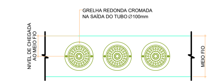
DETALHE-03 SAIDA DO TUBO PVC Ø100 NA SARJETA ESCALA: 1/10
